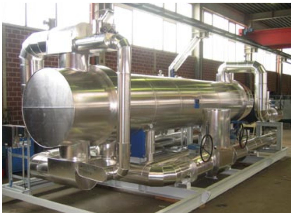
Für die Verpackung fertiggestellter Heater-Skid
