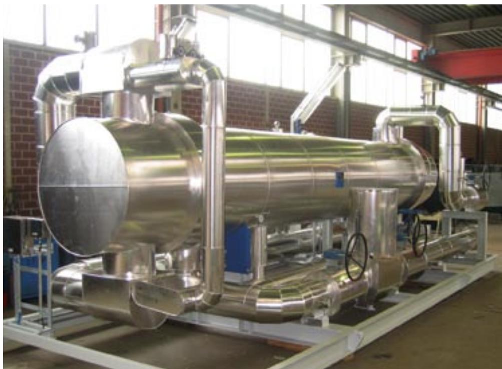
*Für die Verpackung fertiggestellter Heater-Skid*
