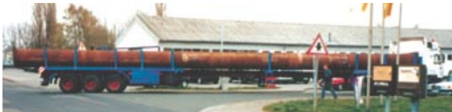
Abtransport von Rohrsteifen DN 1000
